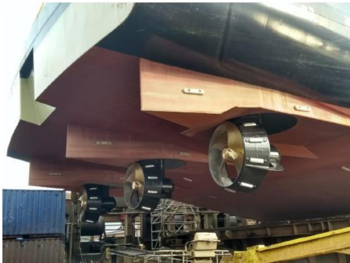
Afbeelding 14: Achtersteven met drie thrusters en een kleinere schroefdiameter voor het varen bij laagwater (Bron: MARIN, Schuttevaer; foto: S. Oudakker, Oudcomb)
