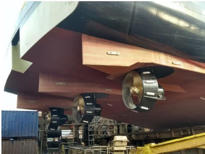
Abbildung 14: Schiffsheckdesign mit 3 Schubdüsen und reduziertem Schraubendurchmesser für den Betrieb bei Niedrigwasser (Quelle: MARIN, Photo: S. Oudakker, Oudcomb)
