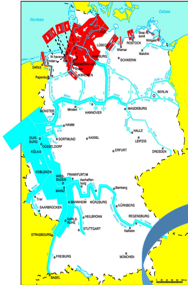
Güterverkehrsichte in Mill t (tkm / Länge der Wasserstraße in km) bis 1 Mill t über 1 Mill t maßstäblich Binnenschiffahrt Seeschiffahrt Quelle: Statistisches Bundesamt Verarbeitet auf der Grundlage der Um- schiffungsdaten der Seehäfen - außer NOK
