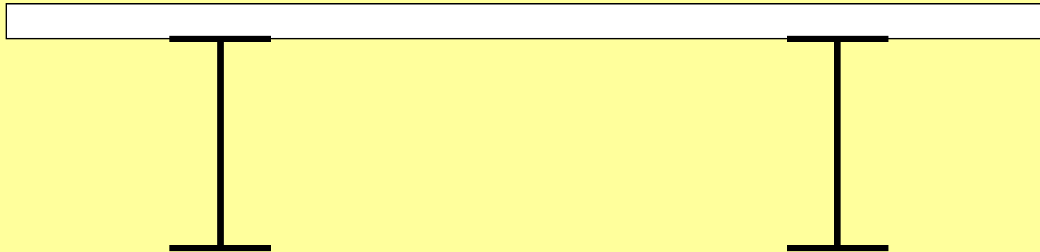
Radartechnisch ungünstiger Brückenquerschnitt (hohe Längsträger mit großem Abstand)
