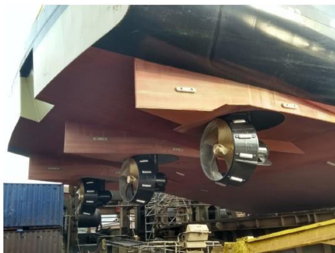
Figure 21 : Conception de l'arrière d'un bateau équipé de 3 propulseurs, le diamètre des hélices étant réduit pour la navigation en eaux peu profondes (source : MARIN, photo : S. Oudakker, Oudcomb)
