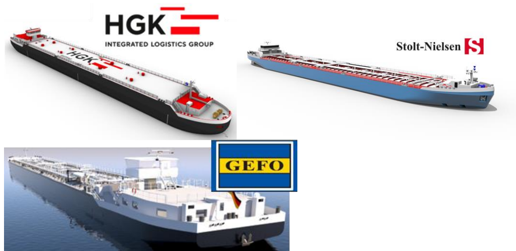
Figure 23 : Nouvelle construction, par BASF, de barges spécialisées pour les basses eaux. (Source : BASF)
