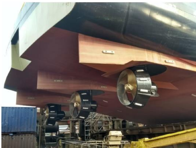
Abbildung 21: Schiffsheckdesign mit 3 Schubdüsen und reduziertem Schraubendurchmesser für den Betrieb bei Niedrigwasser (Quelle: MARIN, Photo: S. Oudakker, Oudcomb)
