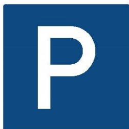
Panneau de signalisation E.5 Autorisation de stationner du côté de la voie d'eau où est placé le panneau.
