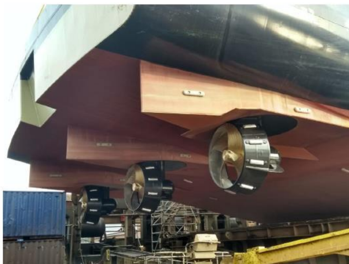
Afbeelding 21: Achtersteven met drie thrusters en een kleinere schroefdiameter voor het varen bij laagwater (Bron: MARIN; foto: S. Oudakker, Oudcomb)
